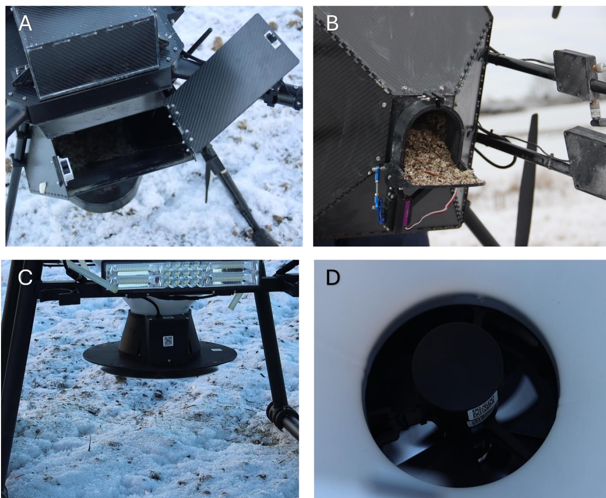
FIGUR 3. Olika spridningsaggregat som användes i koncepttest 2. A. Strängspridare ovanifrån, B. Strängspridare underifrån, C. Tallrikspridare av större modell, placerad under behållaren under drönaren, D. Tallrikspridarens spridningsmekanism ovanifrån, fotograferad inuti behållaren.
