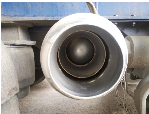
Figur 5. Utblåsrör på kulbil. Foto: Linda Engblom
