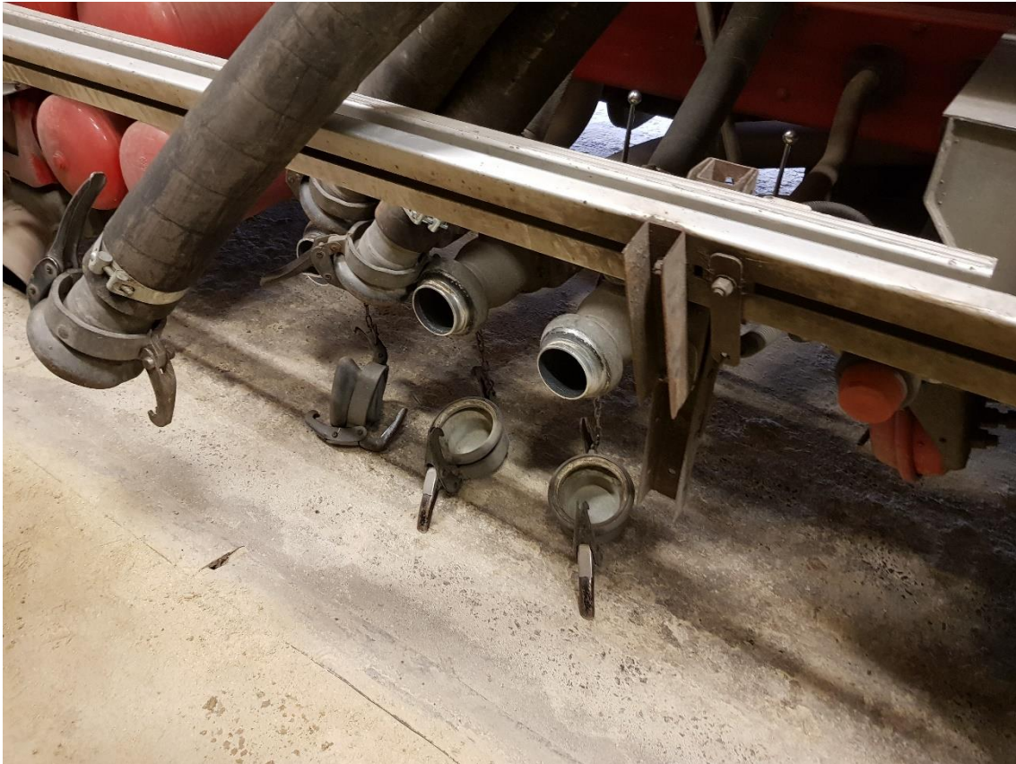
Figur 6. Utblåsrör med lock. Foto: Magnus Thelander
