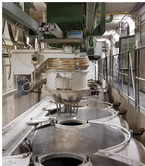
Figur 8. Bälgs för påfyllnad av kulor. Foto: Linda Engblom
